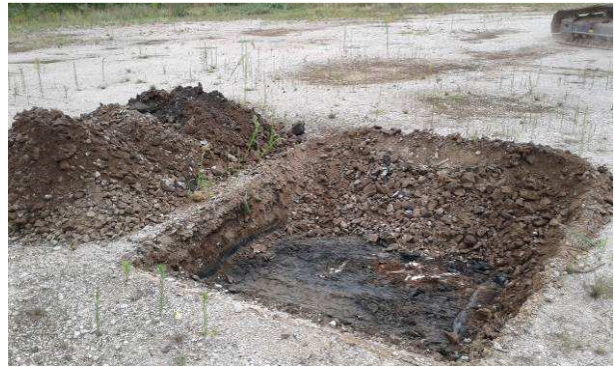
Sondage sur la zone PCB (S8)
